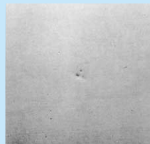
防錆不良によるピンホール模様 Pinhole texture by inappropriate rust proof.
